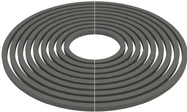
Descrizione: Griglia salvapiante circolare Circle, realizzata in UTC (Ultra Tense Concrete), costituita da due elementi dotati di fori radiali per garantire il passaggio dell'acqua allo strato radicale della pianta. L'allineamento delle stesse viene garantito tramite un controltelaio in acciaio che verrà cementato sotto quota pavimento.
