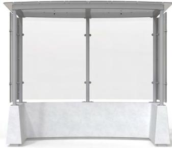
Descrizione: Pensilina Magnum Evolution S, realizzata con basamento in Pietre Preziose Ricostituite o Pietre Ricostituite Granito e dotato di base livellabile, una struttura portante composta da colonne in tubi tondi e una copertura in tubi rettangolari in acciaio verniciato. Le pareti sono chiuse sui 3 lati da pannelli di vetro, mentre la copertura può essere realizzata in pannelli di vetro trasparente oppure serigrafato bianco oppure in pannelli di lamiera verniciata.
