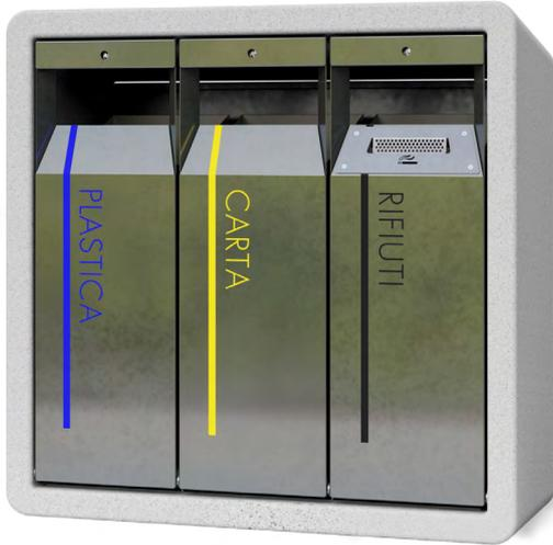
Descrizione: Cestino per la raccolta differenziata Tri, realizzato in Pietre Preziose Ricostituite o Pietre Ricostituite Granito, composto da un elemento monolitico a portale con copertura superiore anti-pioggia e di tre ante in lamiera d'acciaio sagomata con apposite cerniere e serratura. All'interno sono presenti tre contenitori interni in lamiera d'acciaio estraibili per la raccolta dei rifiuti. Disponibile un versione con posacenere in acciaio inox integrato.
